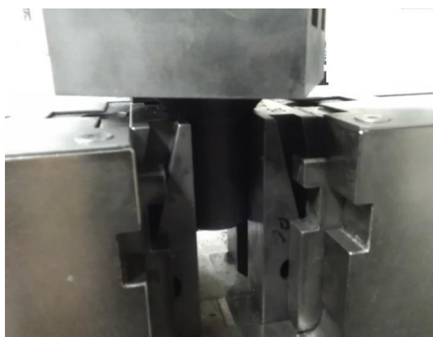
Rys. 10b. Etapy montażu w maszynie wytrzymałościowej urządzenia do mocowania próbek siatek gabionowych
