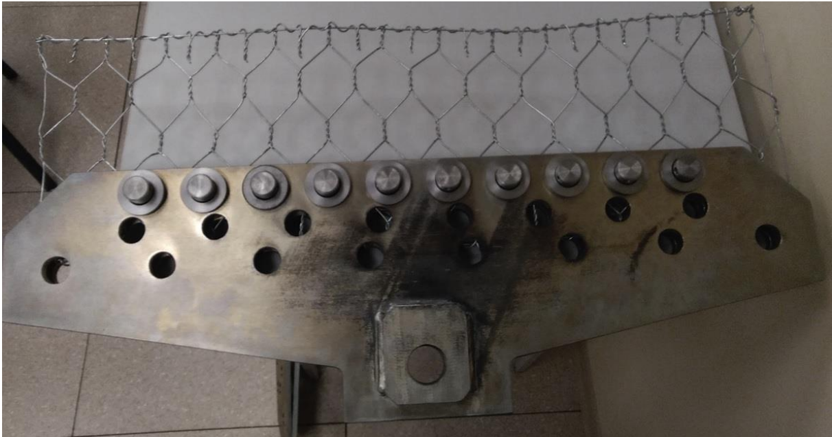
Rys. 9i. Etap montażu części składowych urządzenia i próbki siatki gabionowej
