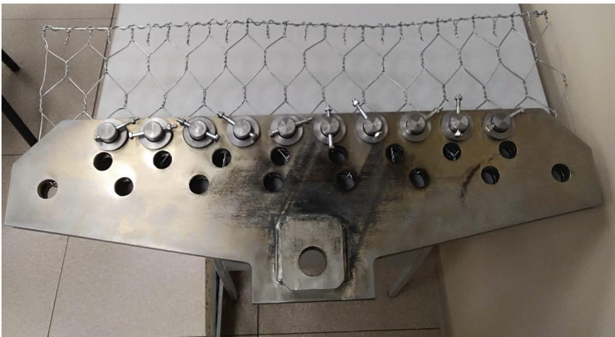
Rys. 9j. Etap montażu części składowych urządzenia i próbki siatki gabionowej
