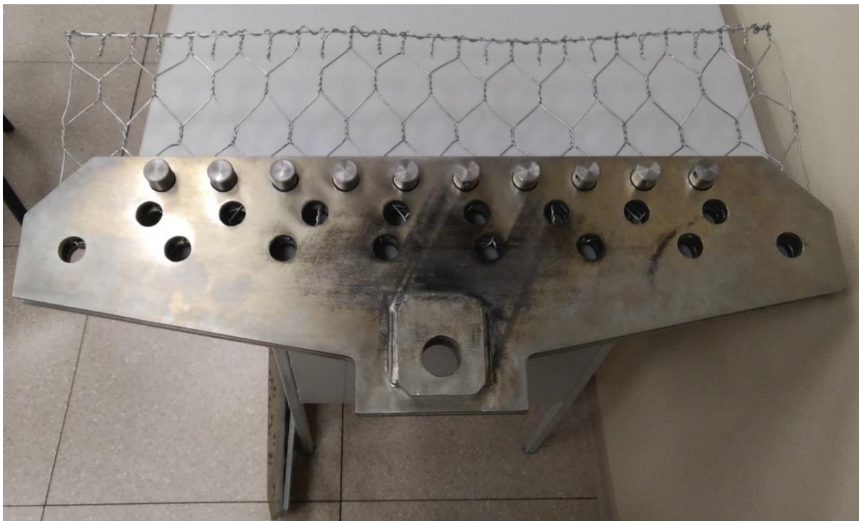
Rys. 9h. Etap montażu części składowych urządzenia i próbki siatki gabionowej
