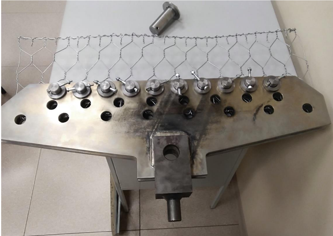
Rys. 9k. Etap montażu części składowych urządzenia i próbki siatki gabionowej
