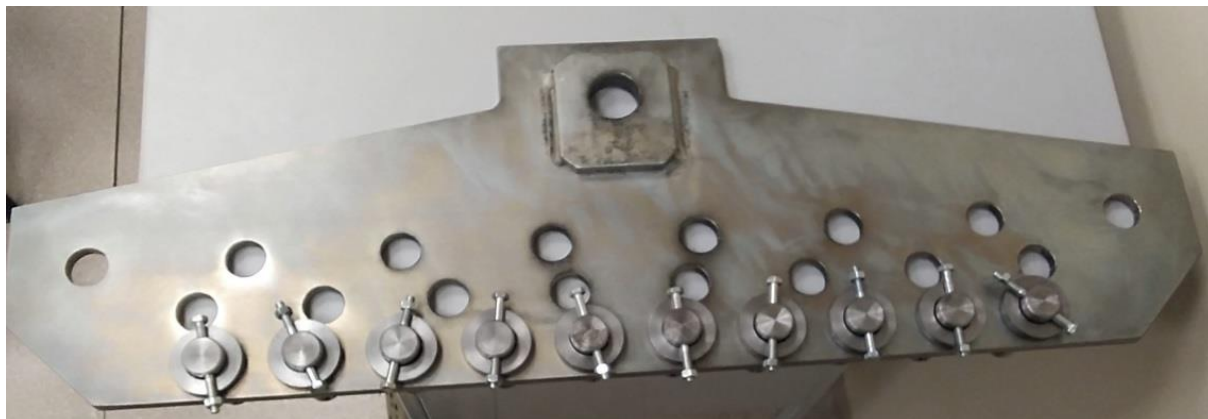
Rys. 9b. Etap montażu części składowych urządzenia i próbki siatki gabionowej
