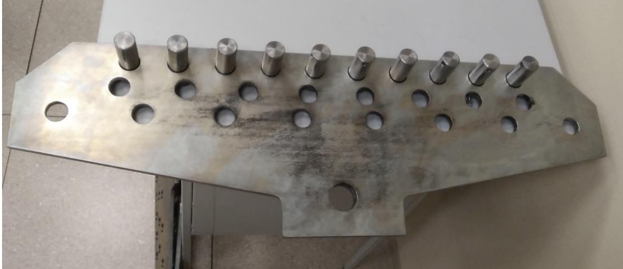
Rys. 9e. Etap montażu części składowych urządzenia i próbki siatki gabionowej
