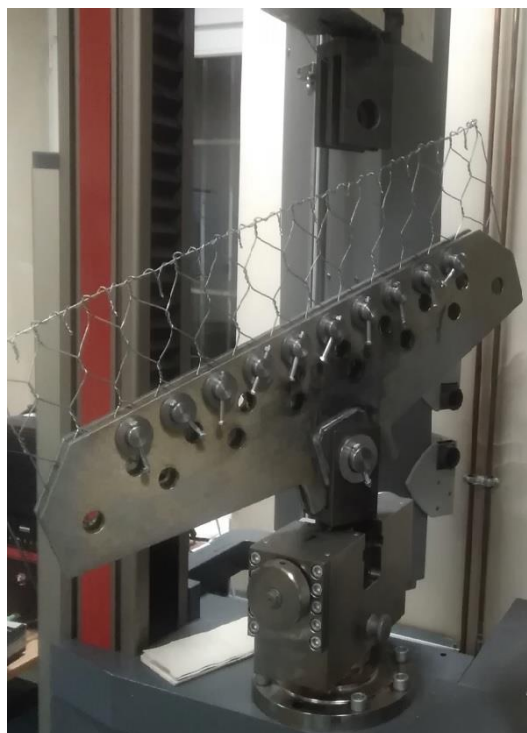
Rys. 10a. Etapy montażu w maszynie wytrzymałościowej urządzenia do mocowania próbek siatek gabionowych
