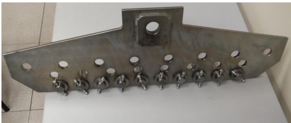
Rys. 9c. Etap montażu części składowych urządzenia i próbki siatki gabionowej
