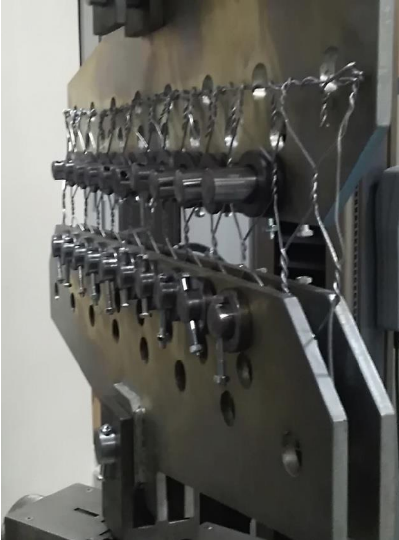
Rys. 10d. Etapy montażu w maszynie wytrzymałościowej urządzenia do mocowania próbek siatek gabionowych
