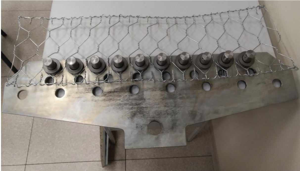
Rys. 9g. Etap montażu części składowych urządzenia i próbki siatki gabionowej
