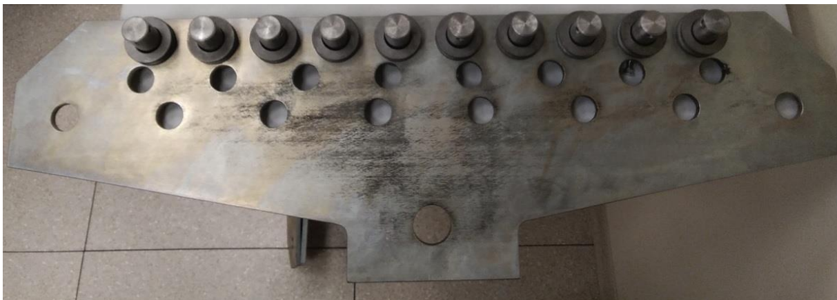
Rys. 9f. Etap montażu części składowych urządzenia i próbki siatki gabionowej
