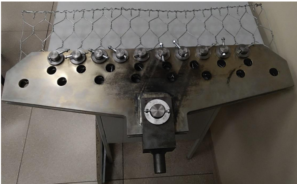
Rys. 9l. Etapy montażu części składowych urządzenia i próbki siatki gabionowej
