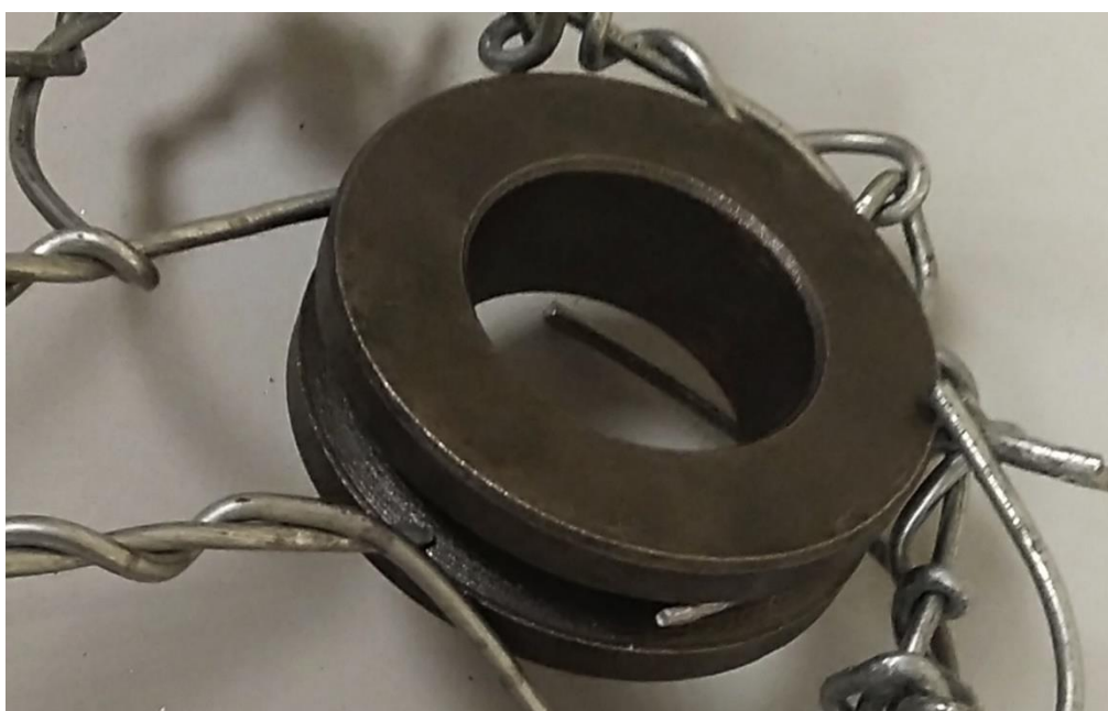
Rys. 11. Lokalizacja miejsca zerwania oczka próbki siatki gabionowej
